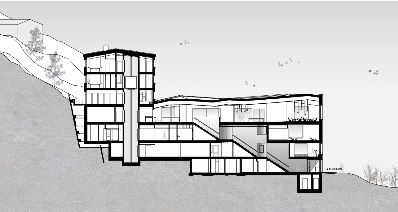
Schnitt durch das Gebäude und die Kaskadentreppe
